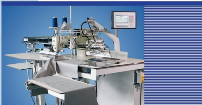
Nähanlage zum Anknäpfen der Schlitzleiste auf linkes Hosenteil, zum Annähen der rechten Schlitzleiste und zum Taschenbesatz aufnähen auf den Taschenbeutel.
